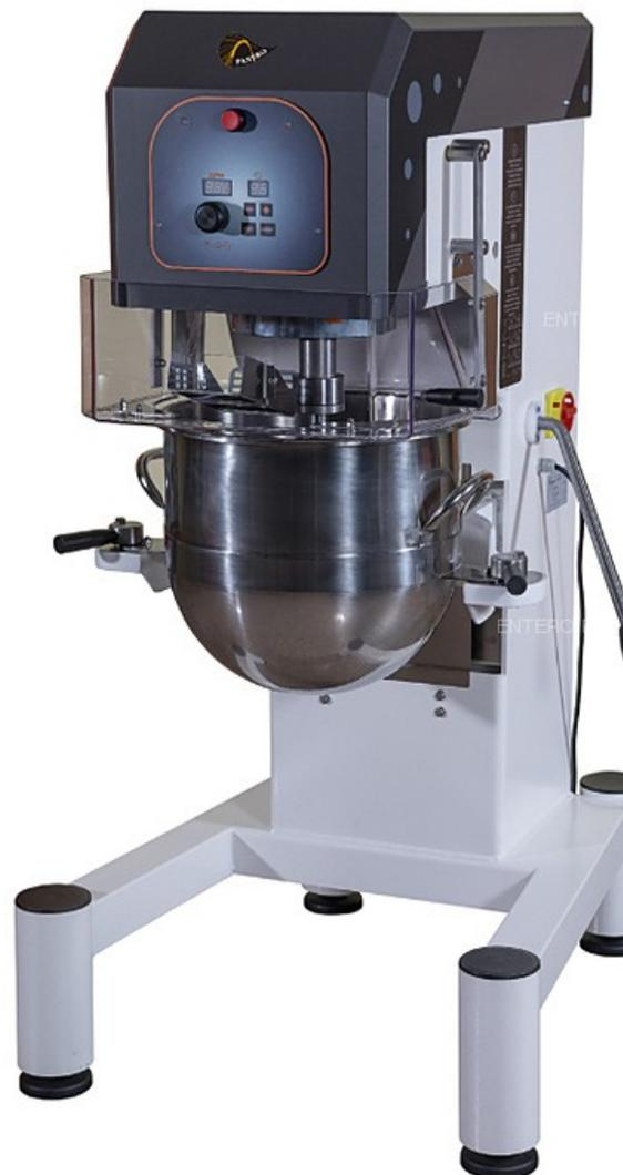
Планетарный миксер **\*\*PANERO 30VE\*\*** предназначен для замеса различного вида теста, а также для приготовления пюре, майонеза и различных соусов на предприятиях пищевой промышленности, общественного питания и торговли. Модель оснащена электронным управлением и редуктором с самосмазочным механизмом. Вал привода выполнен из пищевого алюминия, защитная решетка, рабочие части и их валы - из нержавеющей стали.
