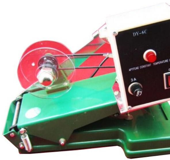
**\*\*Датер ручной DY-6C\*\*** – это малогабаритное устройство, используемое для проставления печатей на упаковке товаров. Прибор адаптирован для работы с разными материалами – алюминиевой фольгой, выделанной кожей, картоном, бумагой, полимерной пленкой, пластмассой и т.п. С его помощью можно указывать дату изготовления, срок годности, массу, номер партии, цену пищевых продуктов, напитков.
